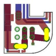
Se si utilizza solo l'interruttore meccanico in dotazione è necessario collegare le piazzole come indicato in figura in giallo
