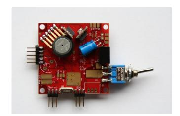
Saldare i Componeti della FC come in figura, il lato raffigurato a destra è quello in BASSO rispetto all'installazione finale sul MK.
