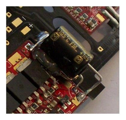
Saldare i 4 condensatori come in figura rispettando le polarità indicare sulla scheda e sul componente
