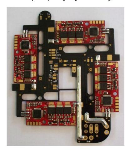
Saldare i regolatori sulla basetta come in figura. Controllare le polarità dei pin prima di dare tensione alla scheda.
