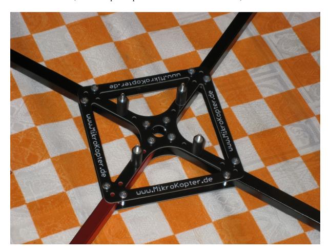
Fissare le viti intermedie con le colonnine antivibranti in dotazione al Kit.
